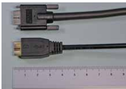
上：USB3 Vision コネクタ(ロック付き) 下：一般の USB3.0 コネクタ
