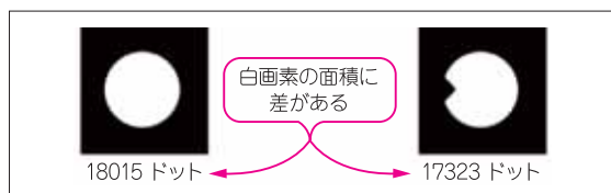
図5-3 対象物の面積を計測して判定
