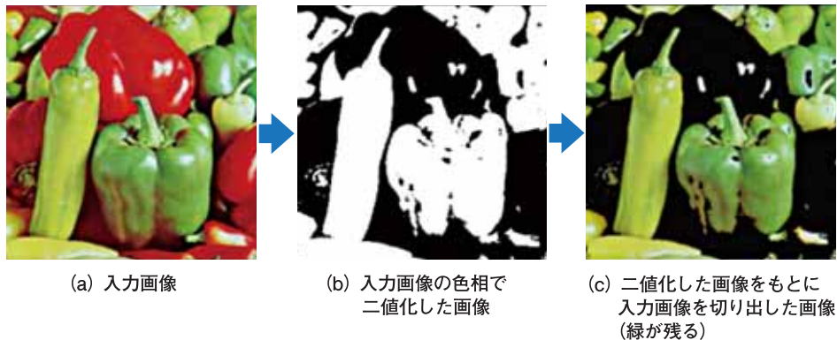
図 3-6 閾値処理を用いた画像の切り出しの例 (入力から画像の切り出しまでリアルタイムで処理される)
