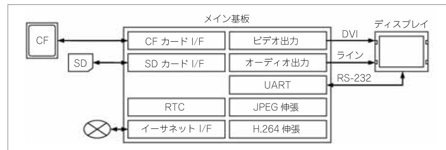
図 2-5 電子看板に使用するメイン基板の構成例
